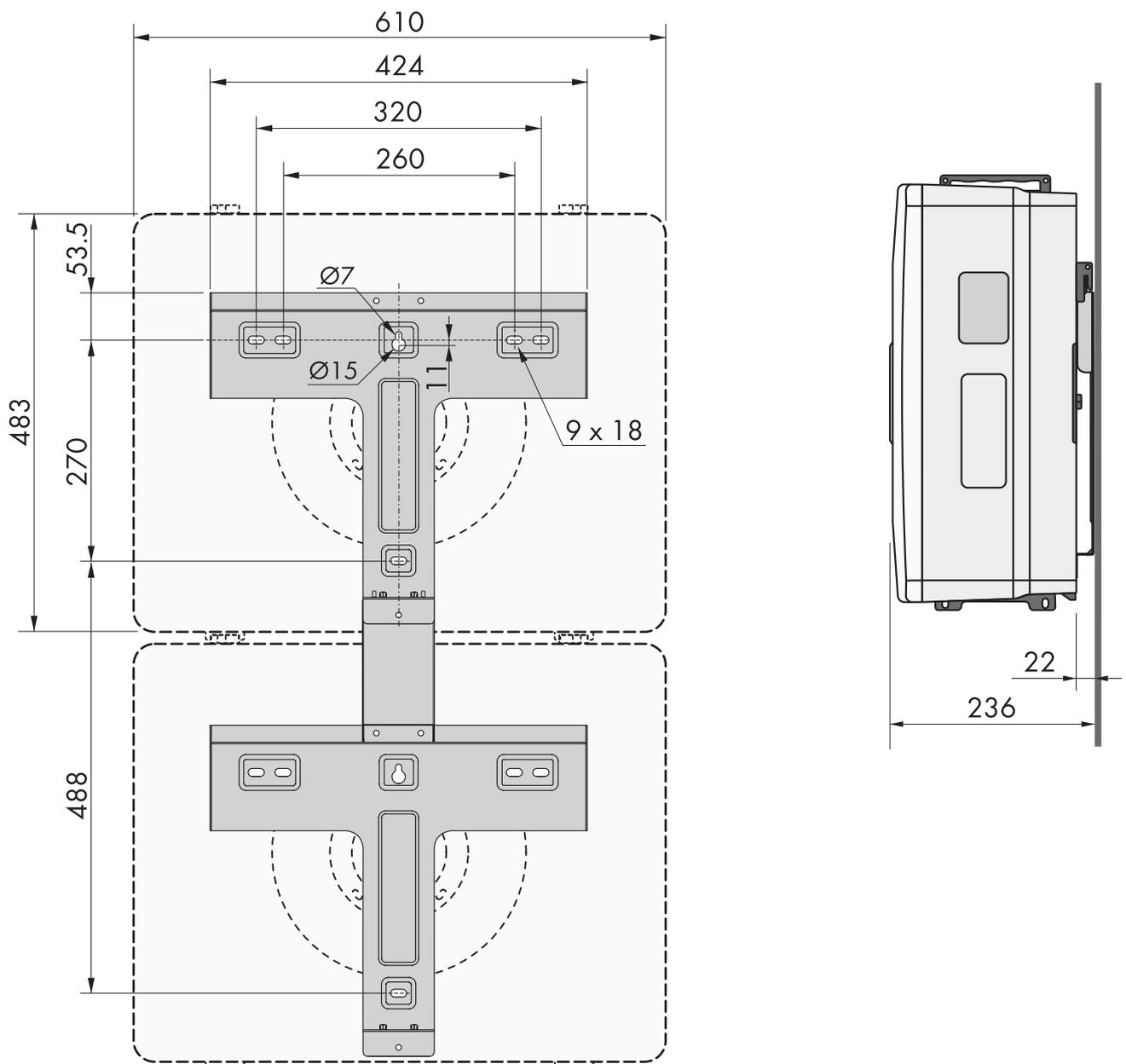
Abbildung 10: Position der Befestigungspunkte (Maßangaben in mm)
