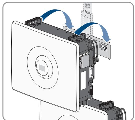
11. Für Batteriemodule direkt übereinander: Batteriemodul links und rechts mit einer mitgelieferten Kombischraube am vorherigen Batteriemodul befestigen (TX20, Drehmoment 2,5 Nm). Sicherstellen, dass das Batteriemodul fest sitzt.
