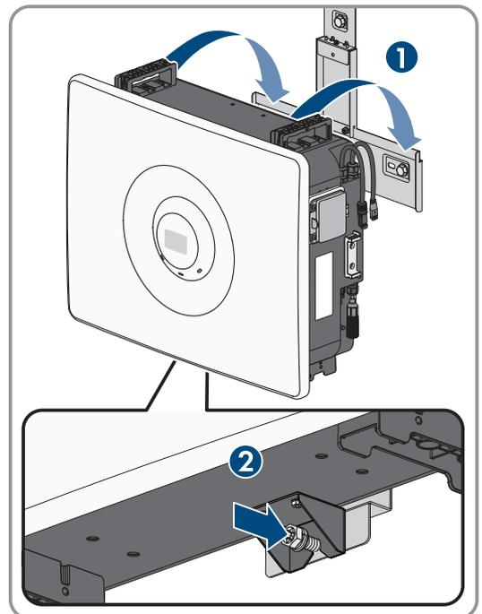
10. Für Batteriemodule direkt übereinander: Weiteres Batteriemodul über dem vorherigen Batteriemodul einhängen.
