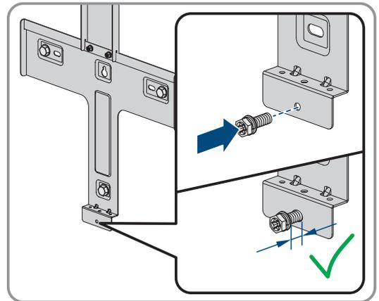
9. Unteres Batteriemodul an Wandhalterung einhängen und mit der mitgelieferten Kombischraube unten sichern (TX20, Drehmoment 2,5 Nm). Dabei müssen die beiden Bolzen rechts und links zwischen den Rippen auf der Rückseite des Batteriemoduls in die Führungsnuten der Wandhalterung eingehängt werden. Sicherstellen, dass das Batteriemodul fest sitzt.
