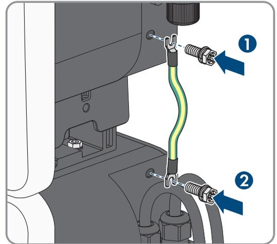
3. Ein für die externe Erdung geeignetes Erdungskabel abisolieren und einen mitgelieferten Kabelschuh an das Kabel crimpsen.
