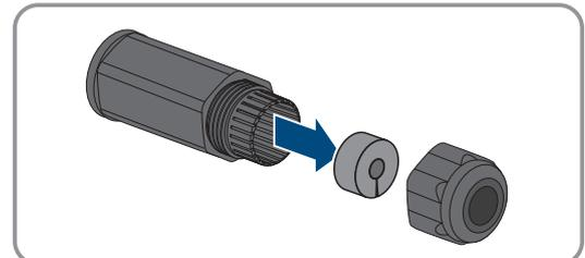
6. Kommunikationskabel in den RJ45-Kabelverbinder stecken. Dabei das Kabel durch die Überwurfmutter und durch den Adapter führen.
