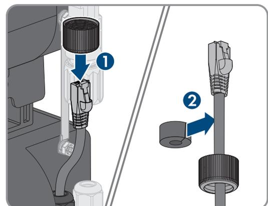
5. Den Stecker durch den Adapter führen und die Batteriekommunikationskabel zusammenstecken.
