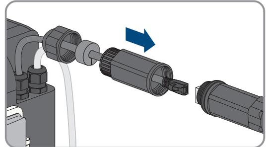
9. Sicherstellen, dass der RJ45-Terminierungsstecker am unteren Batteriekommunikationskabel des letzten Batteriemoduls eingesteckt ist.
