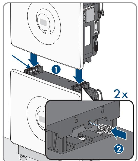
3. Für 3 Batteriemodule: Jetzt den Befestigungswinkel einsetzen, siehe oben. Den vorherigen Schritt für das dritte Batteriemodul wiederholen.
