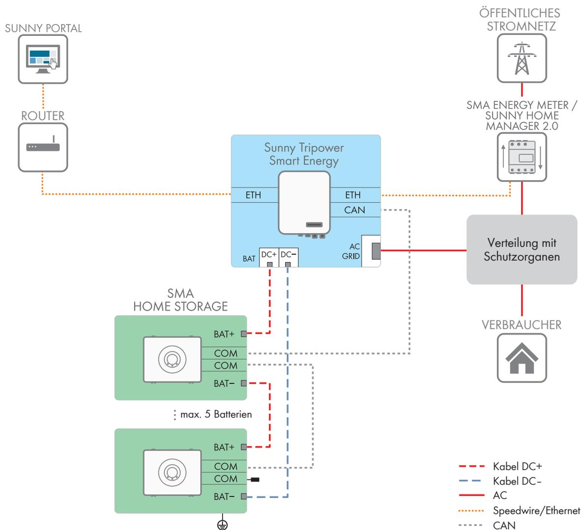
Abbildung 17: SMA Home Storage mit 1 Sunny Tripower Smart Energy (Beispiel)
