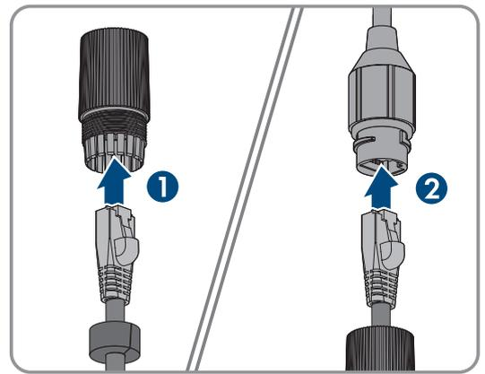
6. Den Anschluss sichern. Dafür Adapter und Überwurfmutter fest anziehen.
