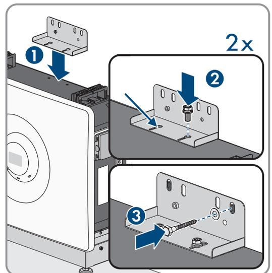
2. Zweites Batteriemodul auf das erste Batteriemodul stellen. Batteriemodul links und rechts mit je einer mitgelieferten Kombischraube am vorherigen Batteriemodul befestigen (TX20, Drehmoment 2,5 Nm). Sicherstellen, dass das Batteriemodul fest sitzt.
