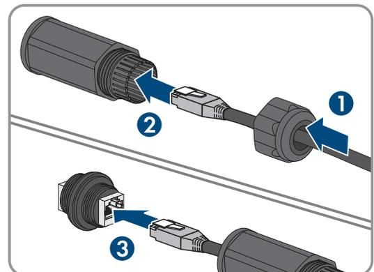
7. Kabeltülle zwischen Überwurfmutter und Adapter anbringen und Kabel sichern. Dafür Adapter und Überwurfmutter fest anziehen.
