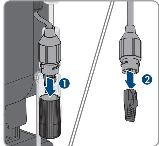
3. Kabeltülle und Überwurfmutter von Adapter lösen. Die Kabeltülle lässt sich von der anderen Seite herausdrücken.
