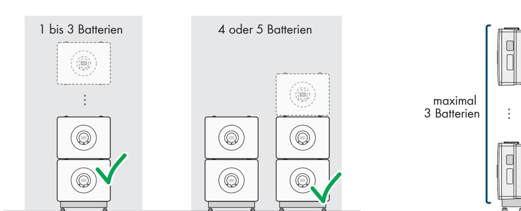
Abbildung 11: Montagevarianten der Montage mit Sockel
