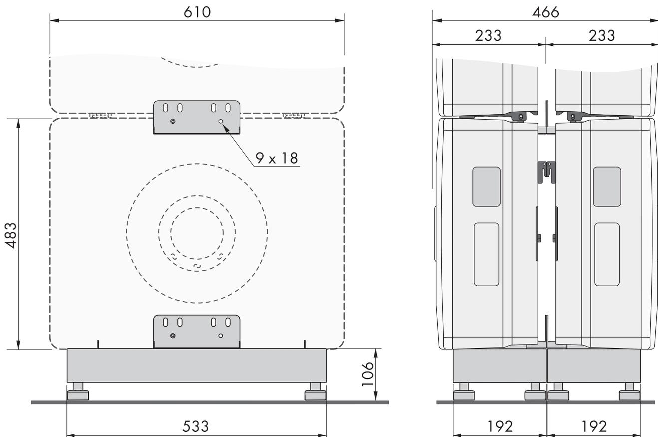
Abbildung 14: Position der Befestigungspunkte (Maßangaben in mm)
