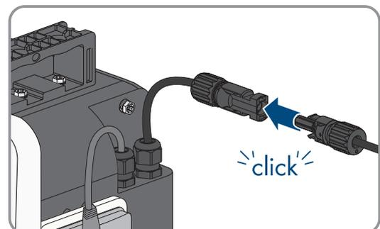
6. Den unteren Steckverbinder **BAT-** des untersten oder ersten Batteriemoduls mit dem Minuspol des Wechselrichters verbinden (siehe Dokumentation des Wechselrichters). Dabei die Polaritätsangaben am Batteriemodul und am Wechselrichter beachten.
