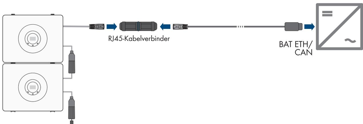
Abbildung 18: Anschlussübersicht der Batteriekommunikation mit dem Wechselrichter
