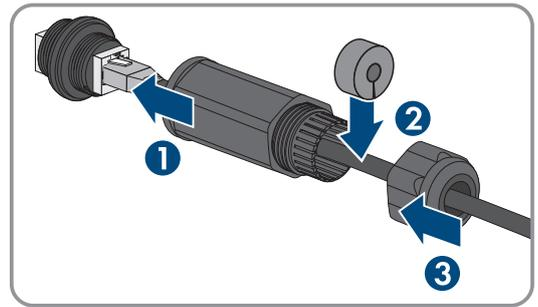
8. Den Vorgang für den Anschluss auf der Batterieseite des Kommunikationskabels wiederholen. Den Anschluss am oberen Kommunikationskabel der obersten Batterie ausführen.
