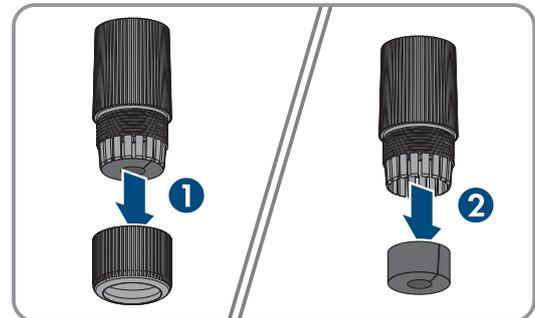
4. Überwurfmutter und Kabeltülle am nächstgelegenen Batteriekommunikationskabel anbringen. Dafür zuerst den Stecker durch die Überwurfmutter führen.
