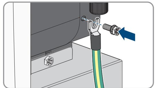
5. Erdungskabel mit externem Erdungspunkt verbinden. Die externen Erdungspunkte von Batterie und Wechselrichter müssen das gleiche Potential haben.
